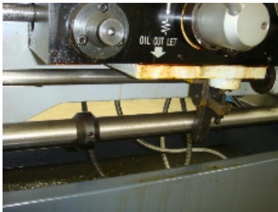
Dispositivos reguláveis de final de curso longitudinal do torno convencional, o qual permite reduzir o curso de deslocamento e agilizar o processo, bem como evitar batidas acidentais do carro na placa.
