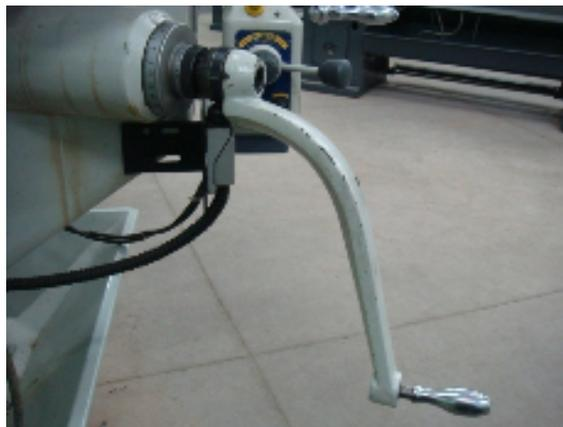
Comando manual para subir e descer a mesa com dispositivo de segurança que impede a operação da máquina quando a alavanca estiver em uso.
