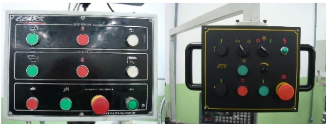
Painel da fresadora universal à esquerda com comandos identificados graficamente e por cores, com maior destaque para a botoeira de parada de emergência. E à direita o painel da fresadora ferramenteira com comandos identificados graficamente e por cores, com maior destaque para a botoeira de parada de emergência.
