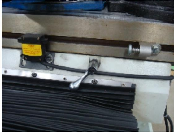
Sensores de final de curso com batentes reguláveis nas fresadoras ferramenteiras, nos três eixos.
