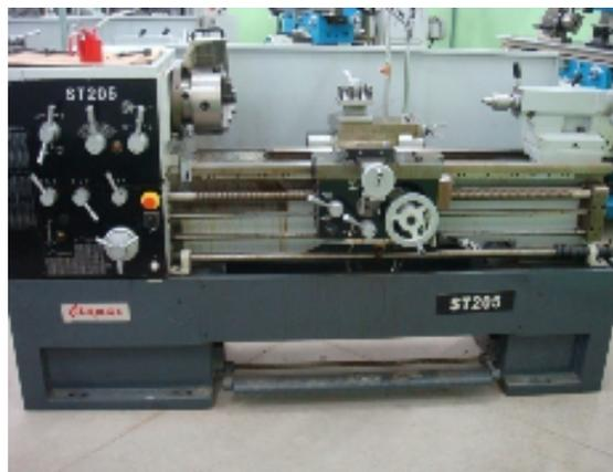
Torno convencional, com seu painel à esquerda mostrando a botoeira de emergência próxima e ao alcance do operador, assim como o pedal de freio motor com parada praticamente imediata.
