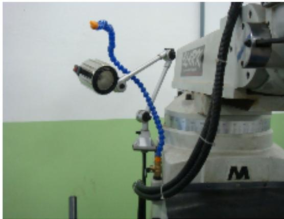
Sistemas de iluminação e lubrificação local nas fresadoras ferramenteiras.
