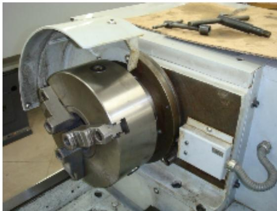
Dispositivo de desligamento do torno convencional acionado pelo sistema de proteção para evitar esquecimento da chave de aperto na placa.
