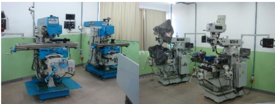
Fresadoras universais (à esquerda) e ferramenteiras (à direita) dispostas em ângulo para permitir maior segurança durante a execução de movimentos longitudinais da mesa.
