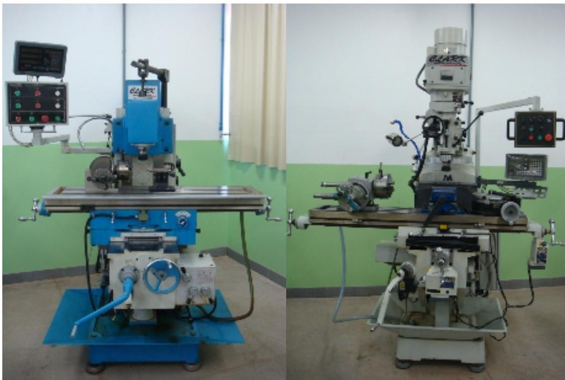
Fresadora universal à esquerda com comandos ao alcance do operador, inclusive a botoeira de emergência no painel de comando à esquerda, na altura dos olhos do operador. E à direita a fresadora ferramenteira com comandos ao alcance do operador, inclusive a botoeira de emergência no painel de comando à direita, na altura dos olhos do operador. Essa fresadora também conta com comandos elétricos para ambos deslocamentos da mesa de operação.
