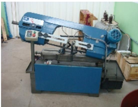
Serra fita horizontal localizada próxima a entrada de materiais, onde são cortados e seguem para os processos com as dimensões mais adequadas, reduzindo o risco de acidentes. Apresenta botoeira de emergência e pistão hidráulico para descida automática com velocidade regulável.
