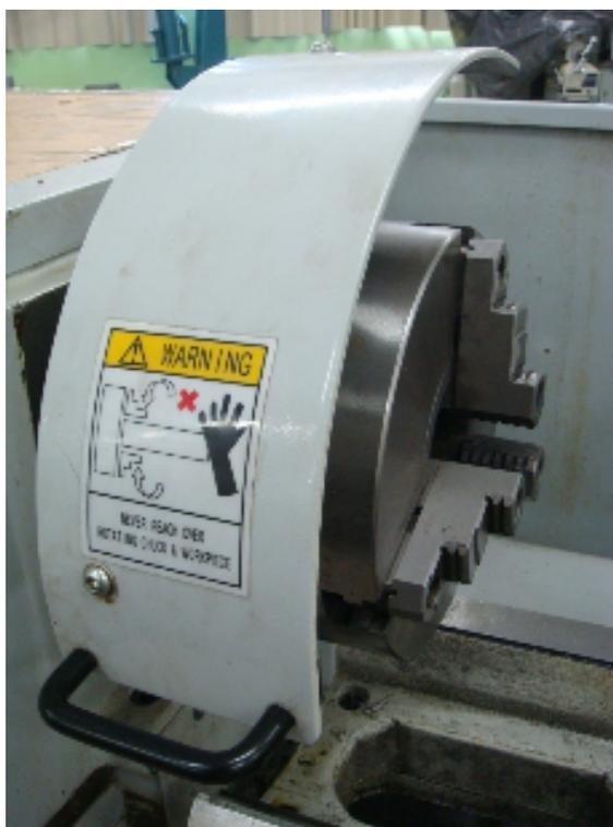
Sinalização de aviso na placa do torno convencional. Sistema de proteção para evitar esquecimento da chave de aperto na placa, podendo causar acidente quando posto em marcha e a chave ser arremessada devido ao torque.
