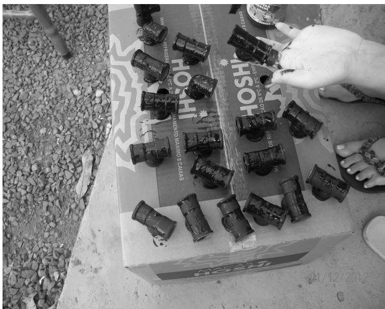
Figura 8- Conexões pintadas com tinta preto fosco Fonte: A autora (2012).
