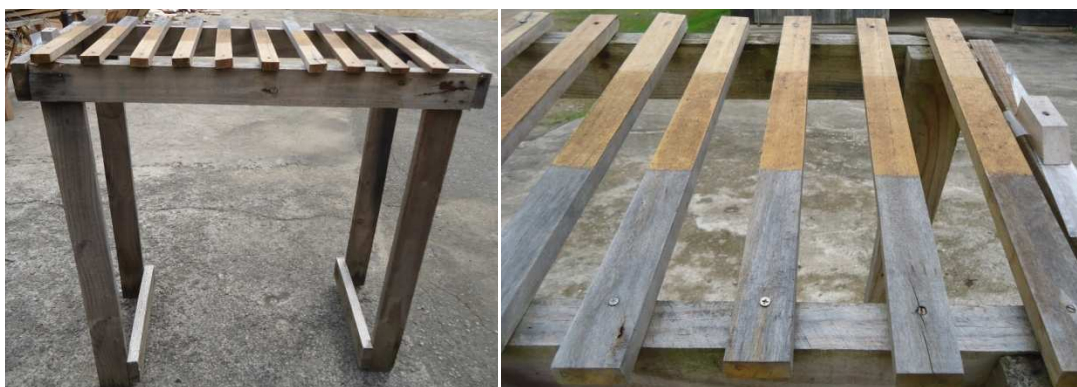
Figura 2. Bancada para exposição das amostras às intempéries.
