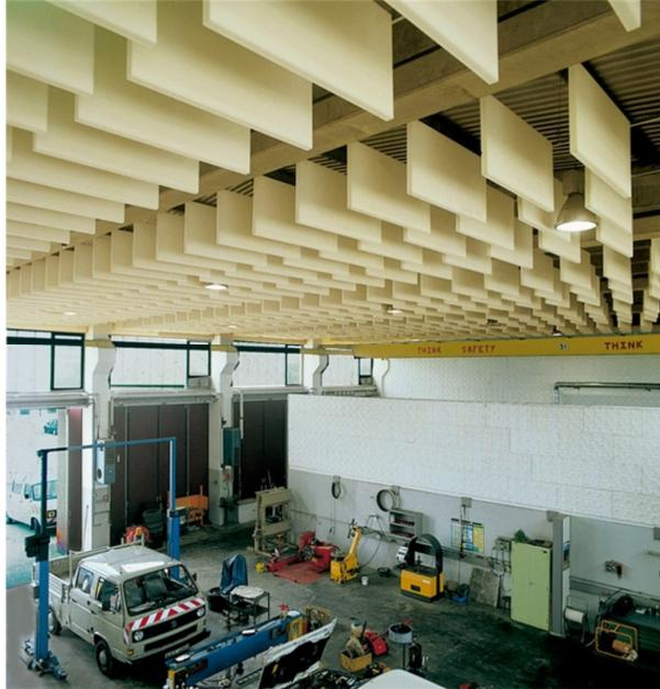
Figura 8. Exemplo de uso de painéis acústicos
