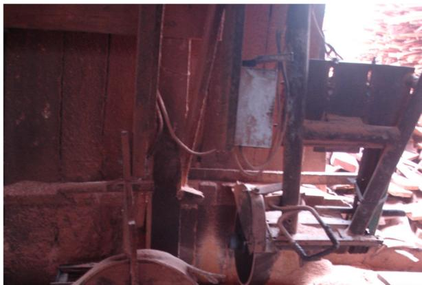
Figura 4. Serra de disco com destopadeira
