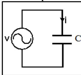
Na Figura 21, um capacitor de capacitância  $C$ , conectado à uma fonte de tensão senoidal  $V_f(t)$ , será percorrido (por indução eletrostática) por uma corrente dada por:
