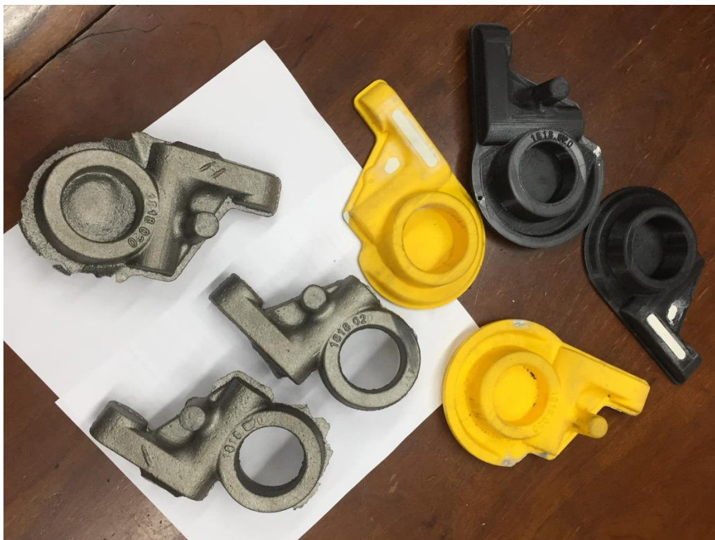
Imagem 3: Modelos impressos em 3D pela Riosulense e peças finais fundidas.
