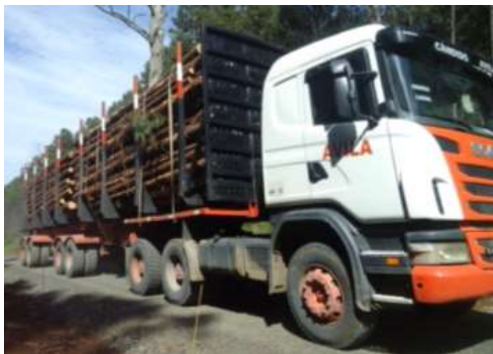
Figura 21. Composição veicular do tipo Bitrem, utilizada para trafegar a via florestal.
