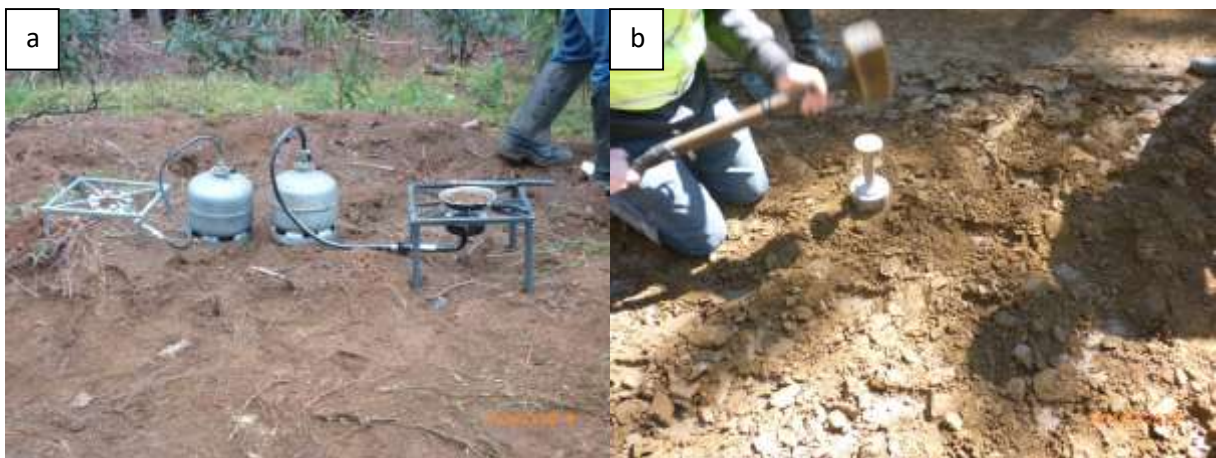
Figura 16. Controle de umidade pelo método da frigideira, e secagem com fogareiro (a) e coleta de amostras de anéis metálicos no solo para o controle de compactação.
