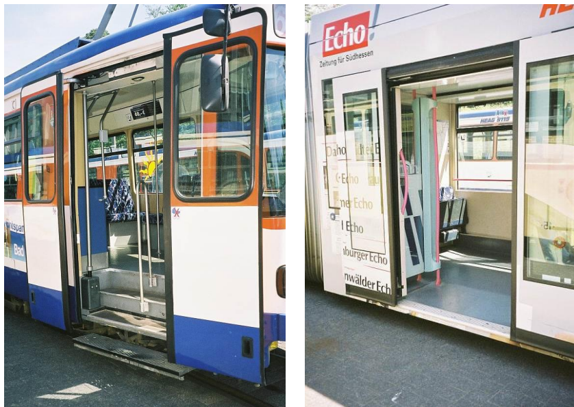
Figura 34 - Comparação de ônibus alemães com degraus (esquerda) e piso rebaixado (direita).
