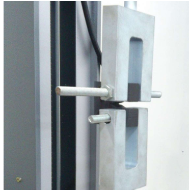
Figura 33 – Corpo de prova tipo CT em posição de início de ensaio de tenacidade a fratura.
