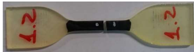
Figura 30 – Corpo de prova de epóxi puro após ensaio de tração.
