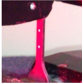
Figura 29 – Corpo de prova de tração de nanocompósito em máquina universal de ensaios mecânicos.
