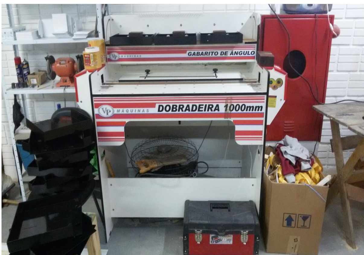
Figura 10 - Máquina de Dobra de produtos em Plástico Fonte: Autora, 2016.
