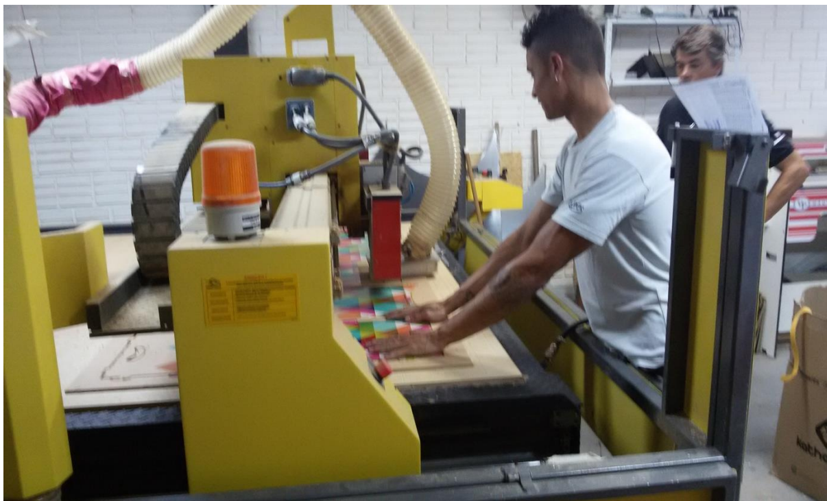
Figura 23 - Operador segurando a chapa durante processo de corte.
