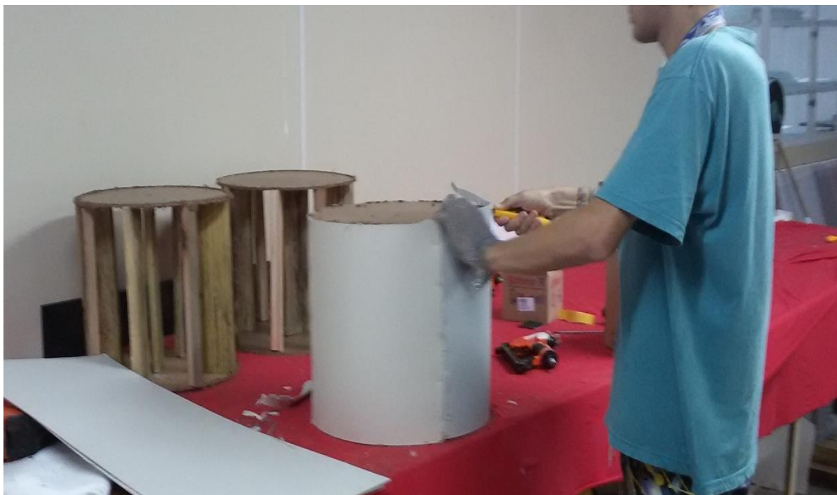
Figura 12 - Montagem da estrutura do pufe Fonte: Autora, 2016.
