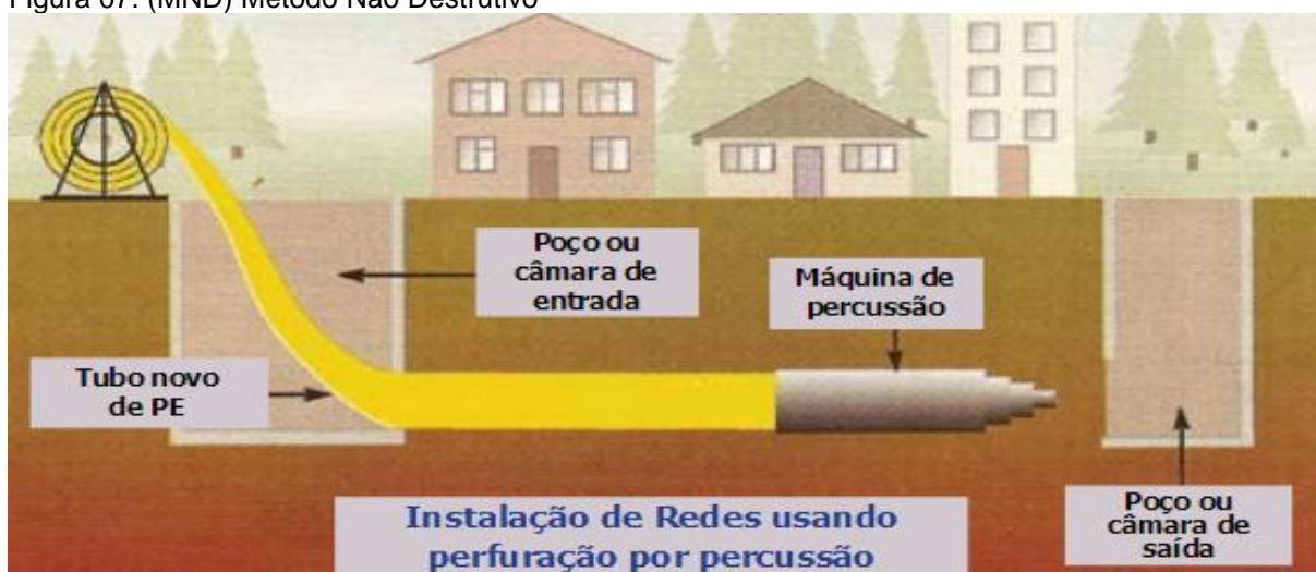
Figura 07. (MND) Método Não Destrutivo
