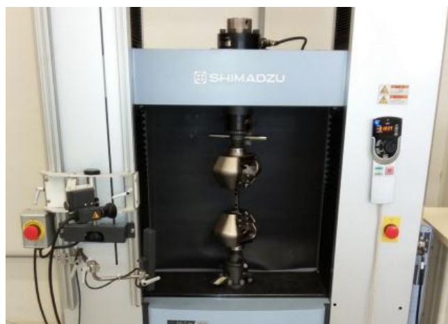
Figura 5 - Máquina universal de ensaios mecânicos SHIMADU AG-PLUS preparada para o ensaio de tração
