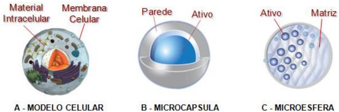
Figura 2 – Comparação do modelo celular entre os tipos de microencapsulação: (b) microcápsula e (c) microesfera
