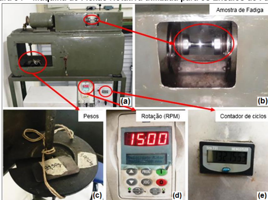
Figura 54 – Máquina de Flexão Rotativa utilizada para os Ensaios de Fadiga
