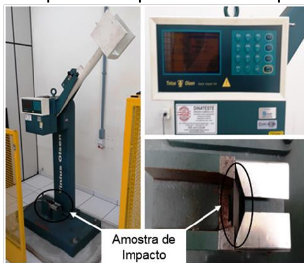
Figura 51 – Máquina Utilizada para os Ensaios de Impacto Charpy
