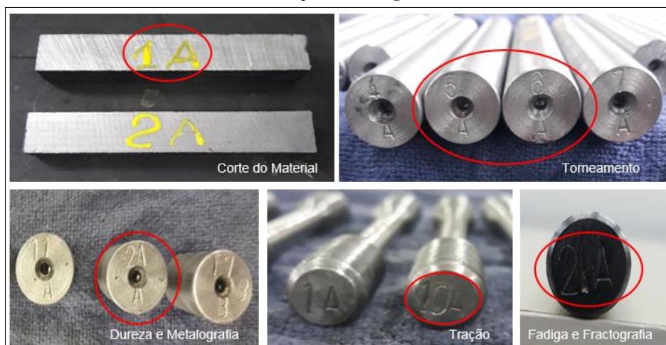
Figura 40 - Identificação das Amostras para os Ensaios de Desgaste, Dureza, Metalografia, Tração e Fadiga
