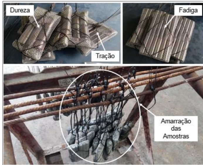
Figura 45 – Preparação e Identificação das Amostras para o Processo de Austêmpera
