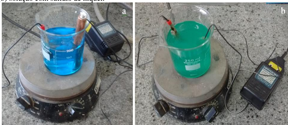
Figura 31 - Esquema de eletrodeposição de cobre e níquel: (a) solução com sulfato de cobre e (b) solução com sulfato de níquel.
