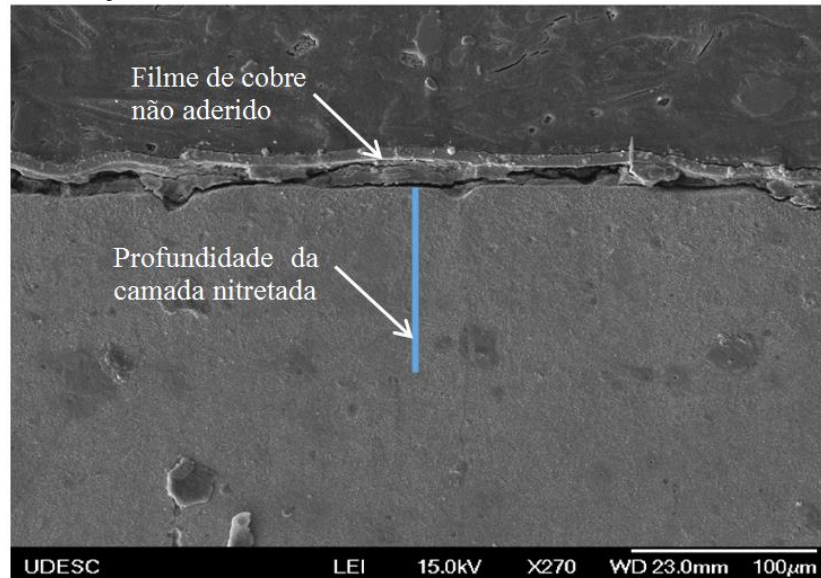
Figura 33 - Micrografia com indicação da profundidade da camada nitretada, obtida por MEV, da amostra de aço SAE 4140.
