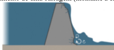
Figura 2 - Galgamento de uma barragem (montante à esquerda)
