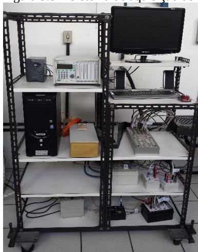
Figura 3.5 – Sistema de aquisição de dados e controle da bancada IBYTU
