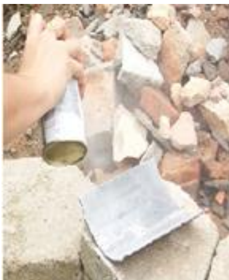
Figura 30: Aplicação do revelador
