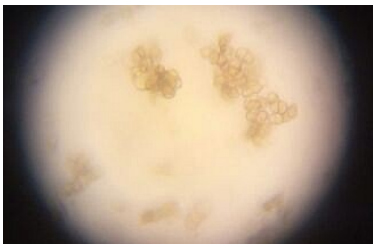
FIGURA 9 - Microorganismos vistos após passagem pela bomba
