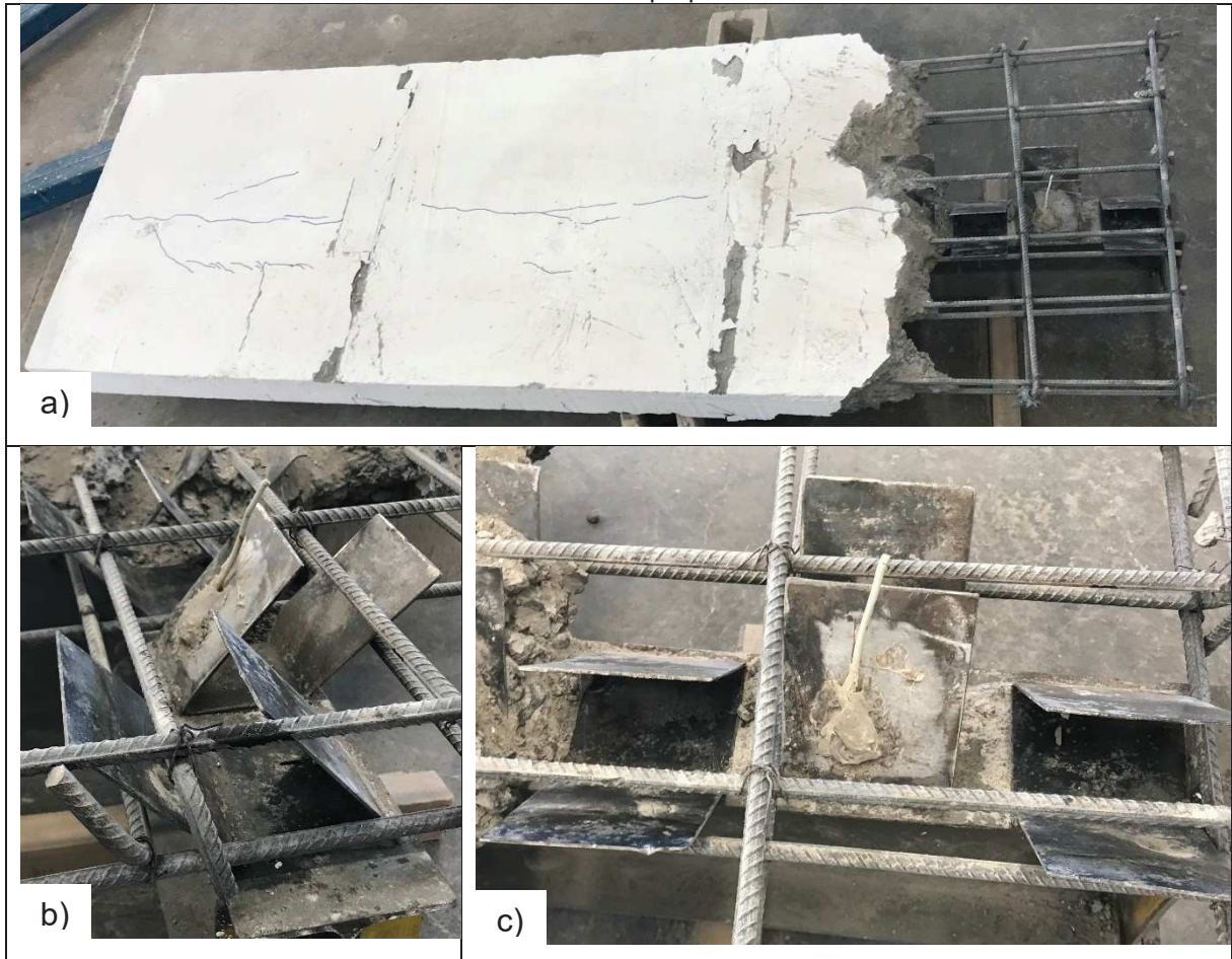
Figura 48 - Rompimento da laje de concreto e verificação do comportamento do conector de cisalhamento proposto
